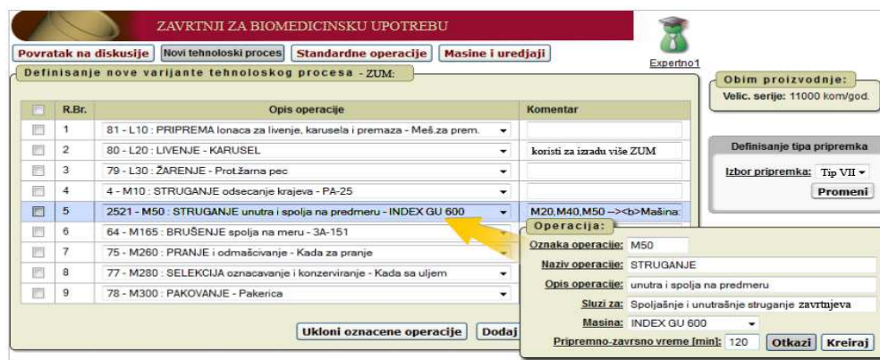
Slika 3. Predlog nove varijante tehnološkog procesa sa definisanjem nove standardne operacije obrade
