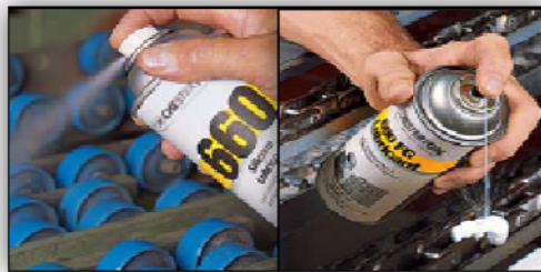
Slika 5. Jedan od načina nanošenja/podmazivanja raspršivanjem, komponenata tehničkih sistema mazivnim sredstvom (660 Silicon Lubricant)
